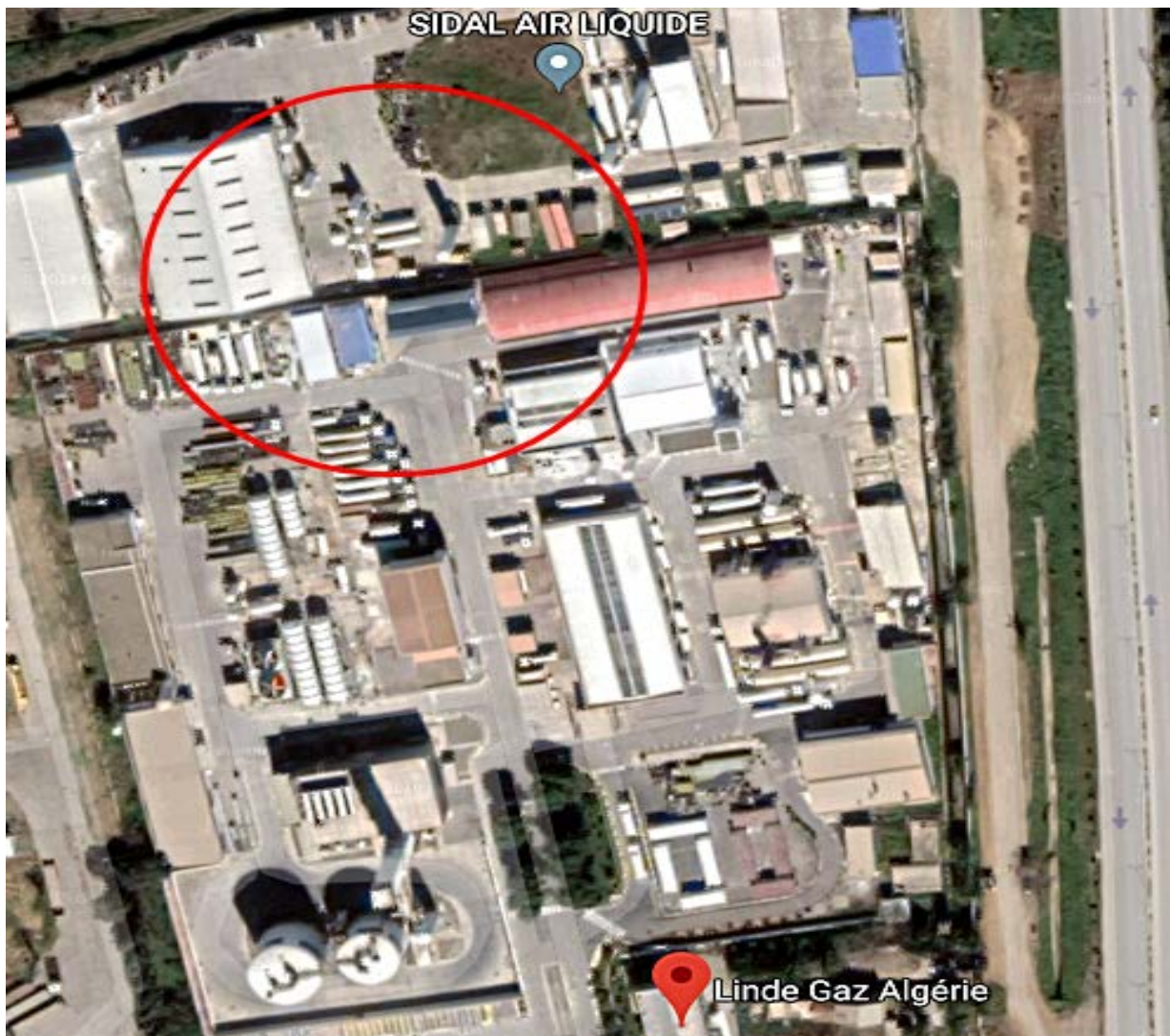
Figure III-3 : Propagation des effets de surpression pour l'événement VCE au niveau de l'atelier d'oxyde d'éthylène
