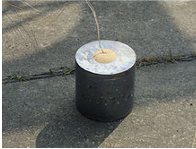
FIGURE 2.1: Dispositif expérimental du test de Trauzl
