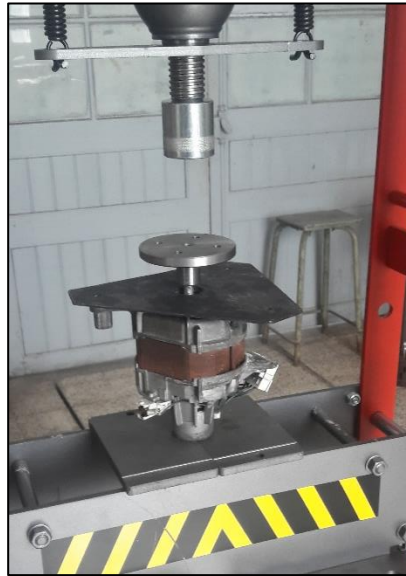
Figure 123- Montage de la bride de transmission
