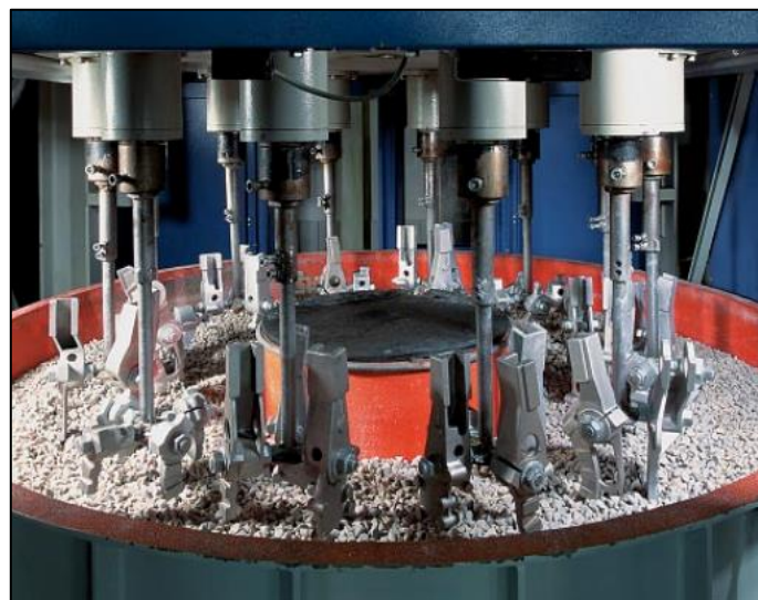
Figure 52- fonctionnement d'une machines à broche [37]
