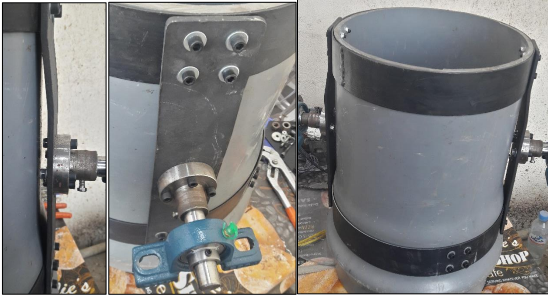
Figure 117- Montage de la chambre de travail
