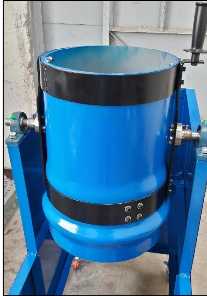
Figure 127- la chambre de travail après montage
