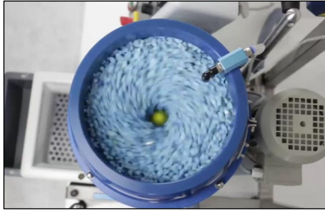
Figure 62-Centrifugeuse à fond tournant lors du traitement
