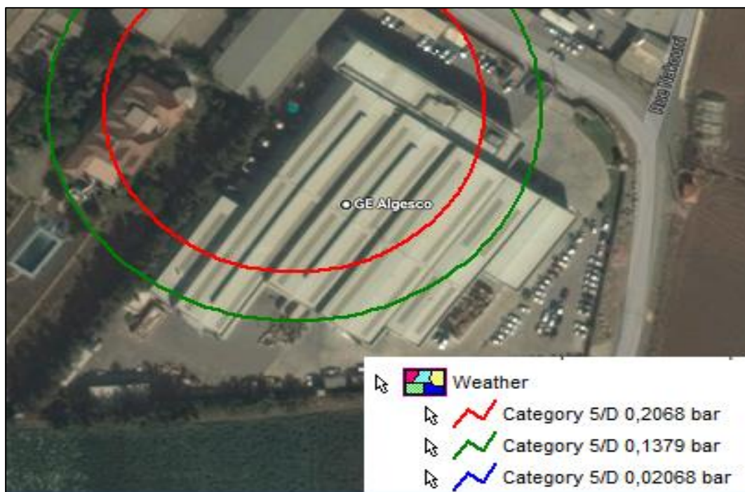
Figure 37 : Périmètres de seuils critiques de surpression due à l'explosion du silo d'hydrogène
