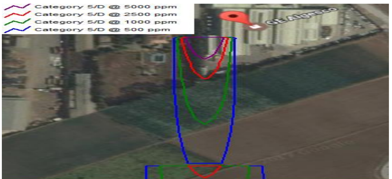
Figure 62 : Périmètre de dispersion de l'acide fluorosilicique
