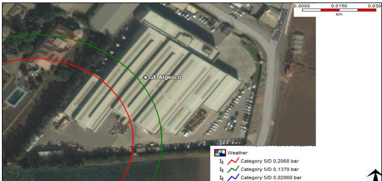
Figure 39 : Périmètres de seuils critiques de surpression due à l'explosion de la bouteille de propane
