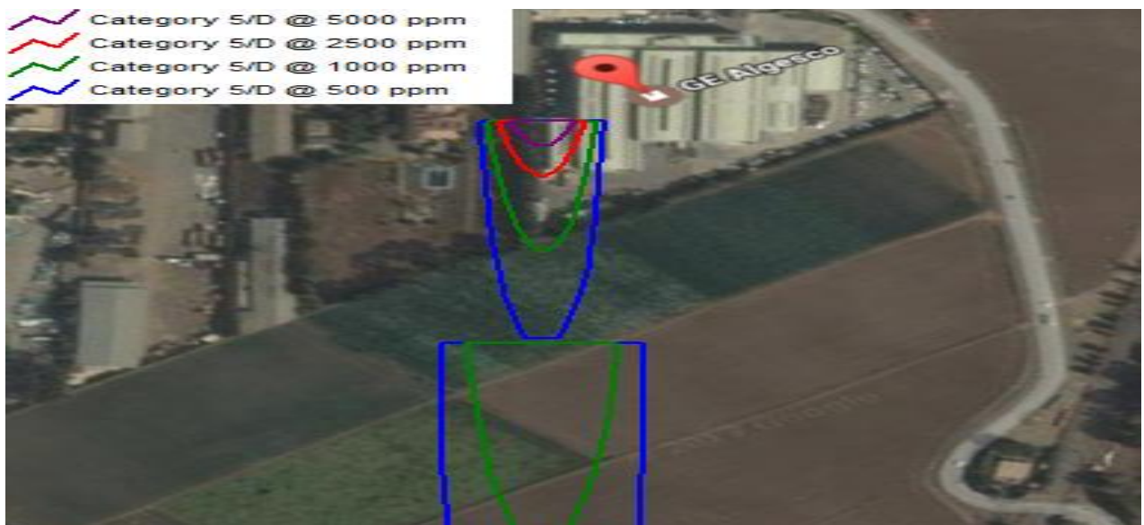
Figure 61 : Périmètre de dispersion de l'acide chlorhydrique
