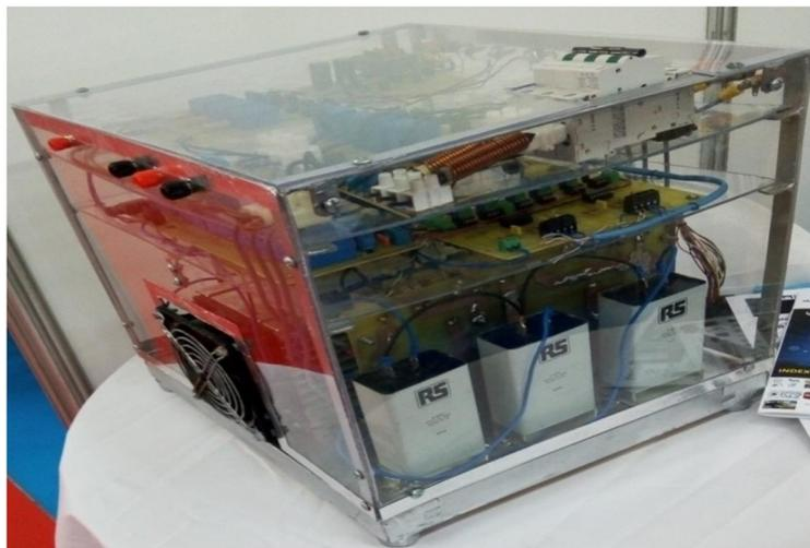
**Figure 5.1** : Prototype du convertisseur matriciel direct.
