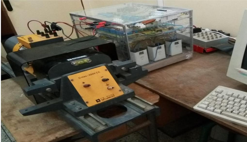
**Figure 5.11** : Banc d'essai expérimental utilisé pour la DTC.
