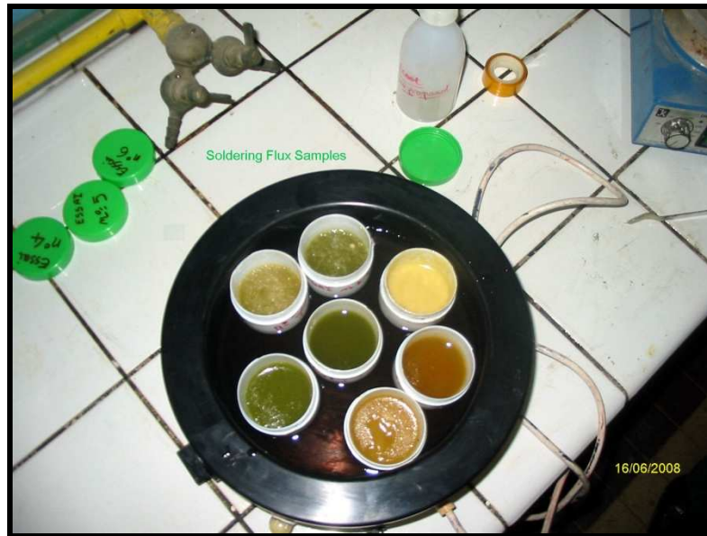
Figure 3 : Aspect des échantillons préparés. La couleur varie selon les ingrédients ajoutés à la colophane.
