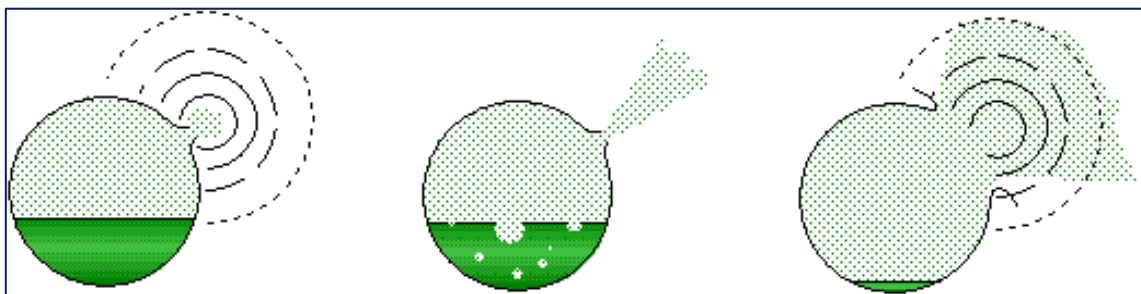
Figure 4.2. Deux ondes de pression, par détente du ciel gazeux puis par ébullition violente
