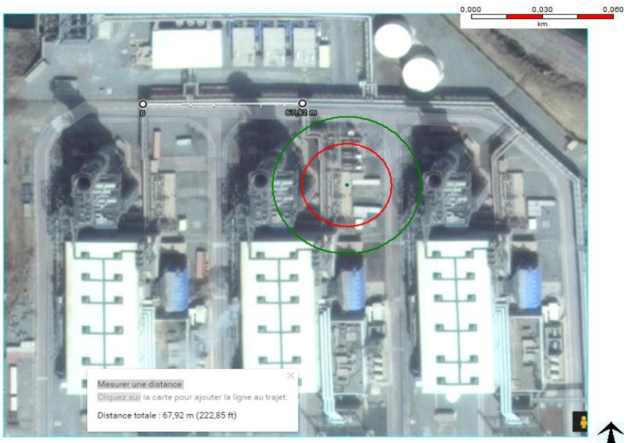
Figure 4-21 : Seuils des dégâts très graves et des effets domino sur les structures (300 et 200 mbar).
