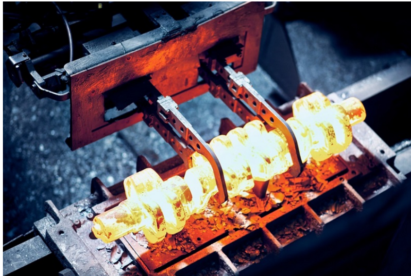
FIGURE 1.1 – Procédé de forgeage d'un vilebrequin de voiture.
