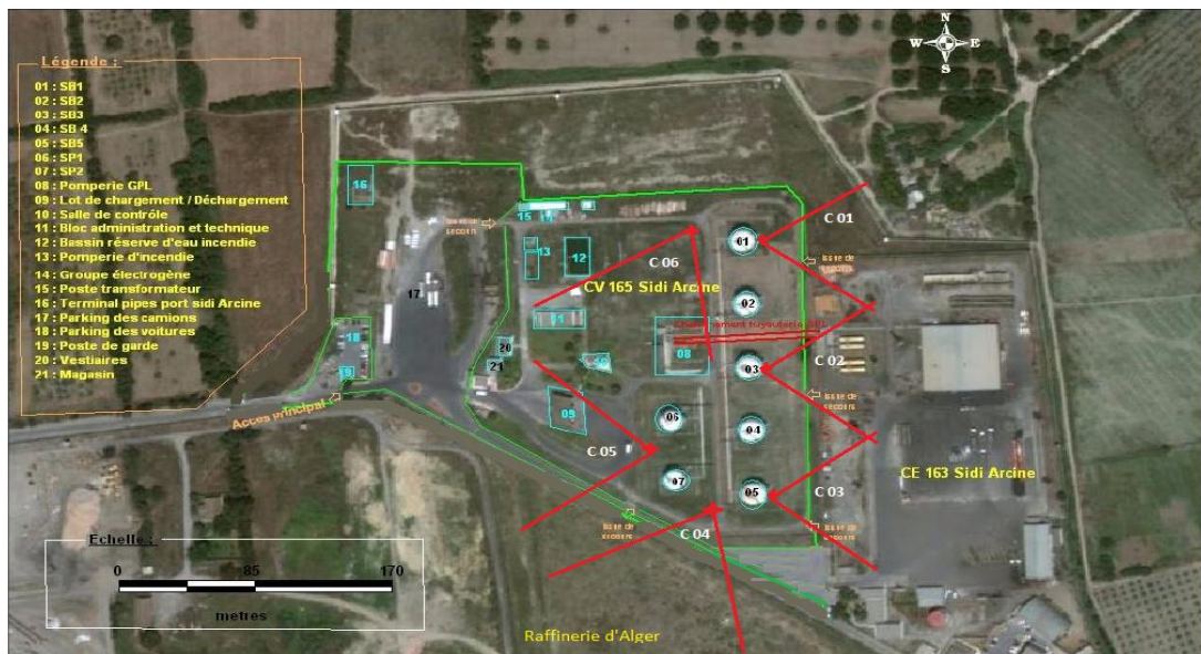
Figure VI-4 : la localisation des détecteurs Multi-IR
