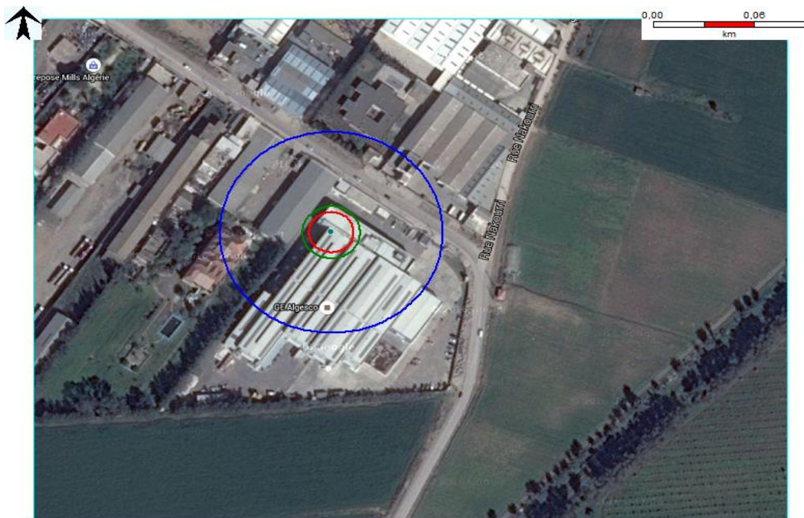
Figure 4-5 : Effets de surpression dans la zone (l'explosion du four sous-vide).
