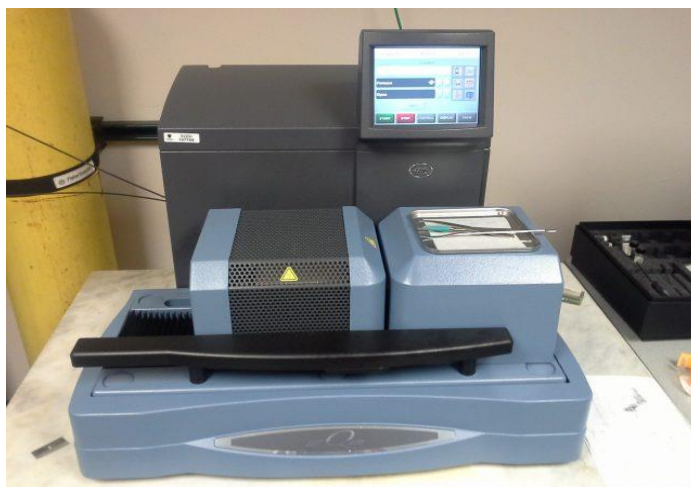
Figure II. 3 : Appareil d'analyse thermique (modèle SDT Q 600-TA).
