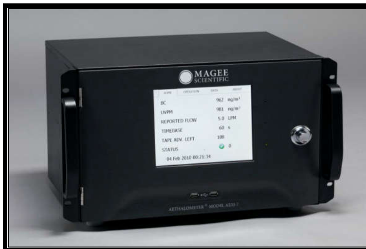
Fig. 11. Aéthalomètre AE33 utilisé pour la mesure du black carbon à Alger
