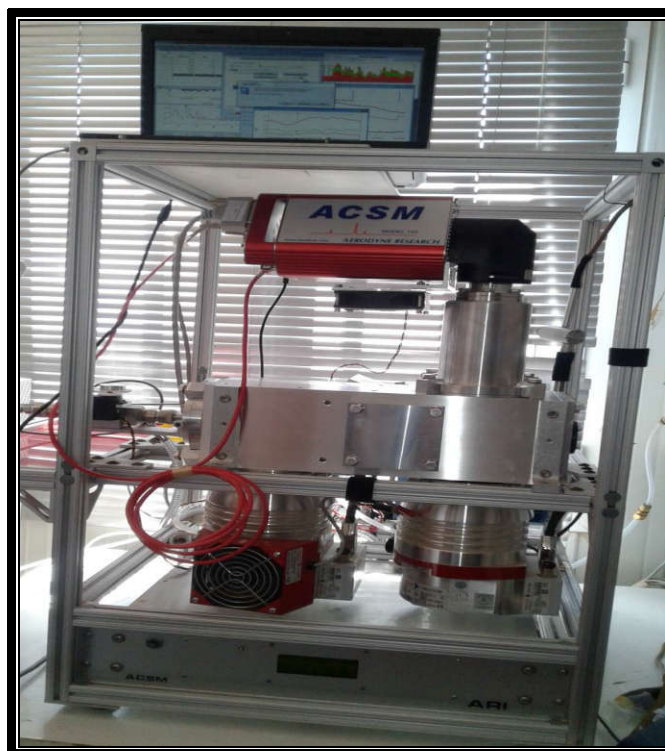
Fig. 12. Aerosol Chemical Speciation Monitor (ACSM) utilisé à Crête pour la mesure de cinq aérosols
