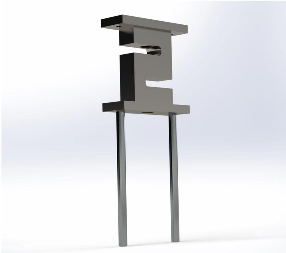
*Figure 2-23: Système de transmission de mouvement*
