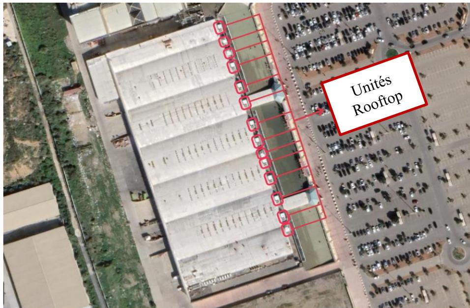
**Figure 1.2.** Répartition des 14 unités de toiture Rooftop sur le toit de Ardis. (*Capture vue satellite – google earth*)
