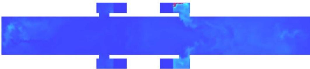
Figure 71 : La visibilité à  $z=1$ m à  $T_0+4$  min niveau des quais (position 3)
