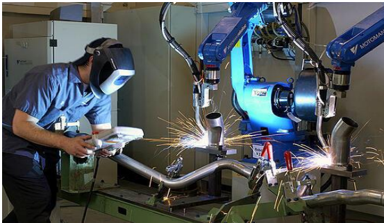
FIGURE II.3 soudure à laide d'un robot anthropomorphe à six axes
