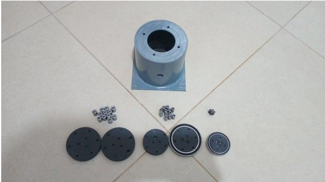
FIGURE III.18 Pièces réalisées par tournage
