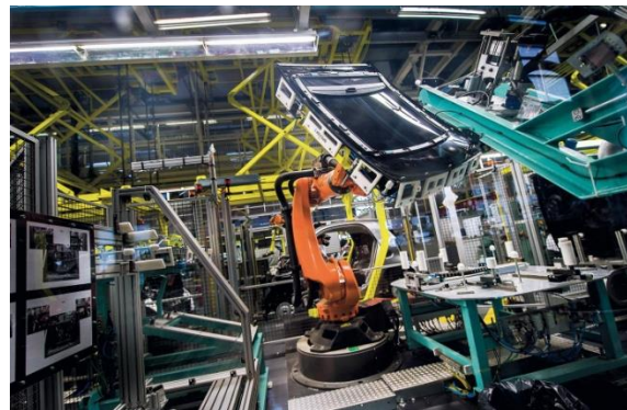
FIGURE II.6 dépôt de la résine a l'aide d'un robot anthropomorphe à six axes
