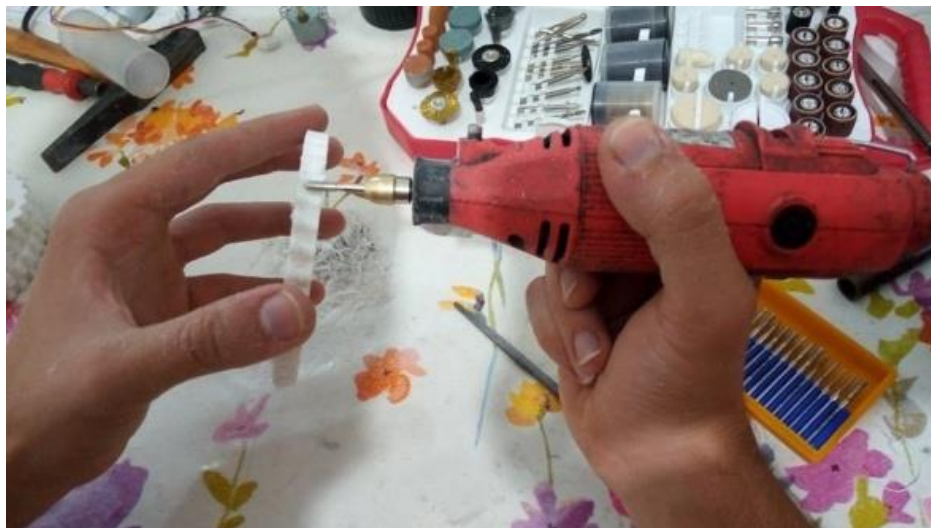
FIGURE III.21 Ajustage de la cycloïde
