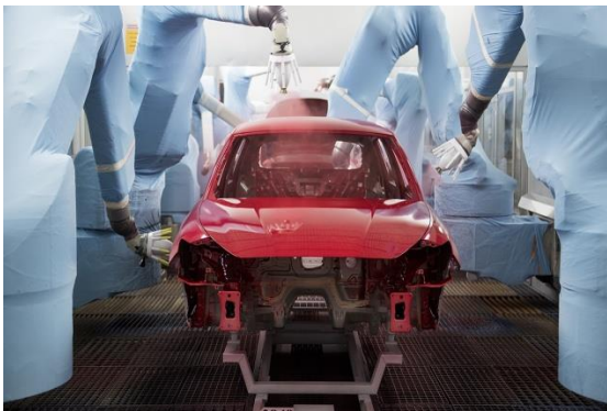
FIGURE II.5 Peinture à laide de robots anthropomorphes à six axes
