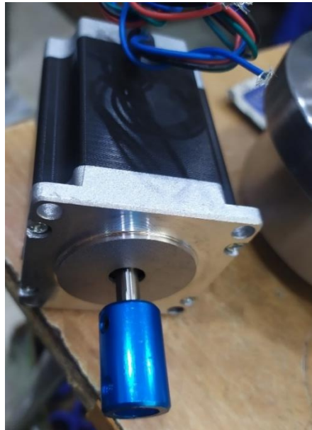
Figure 4.22: Moteur pas à pas Nema 23 et sont accouplement
