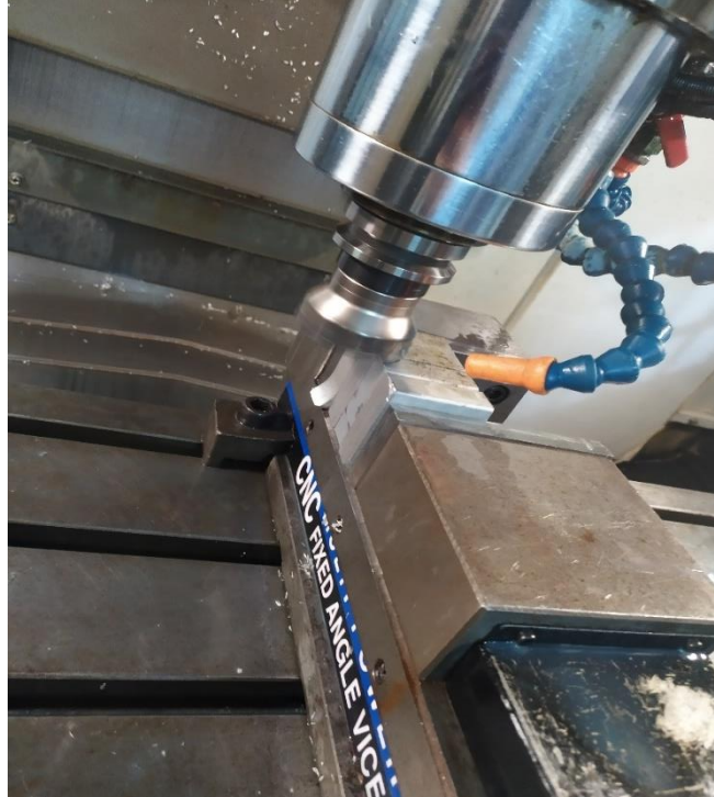
Figure 4.6: Usinage des supports d'axes avec fraiseuse à commande numérique
