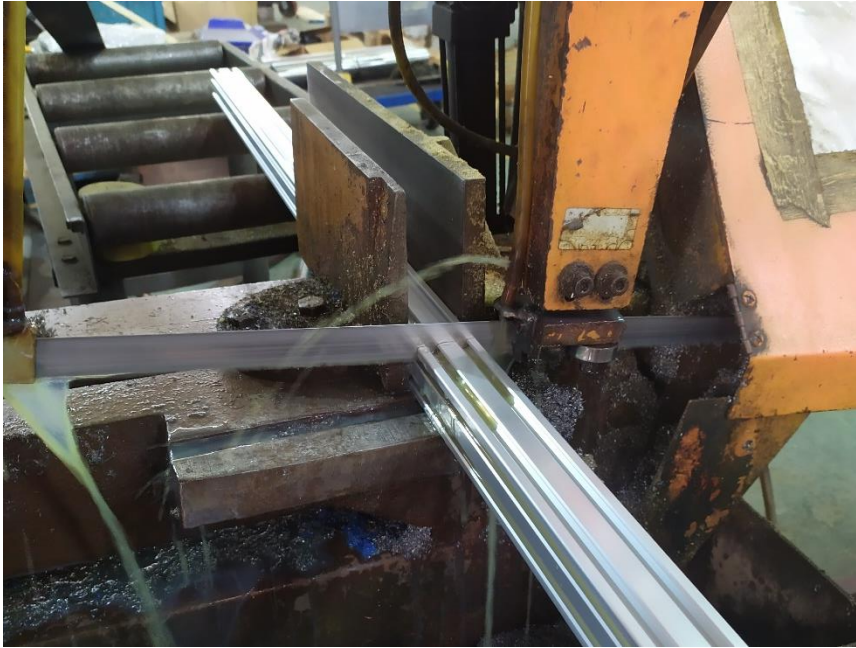
Figure 4.1: Mise en longueur d'une glissière V-slot avec une scie électrique
