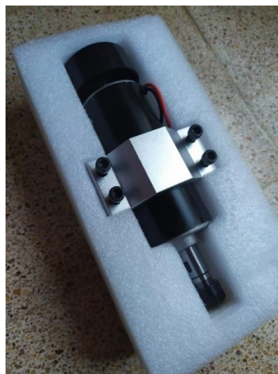
Figure 4.23: Moteur broche de 500W montée sur le support broche
