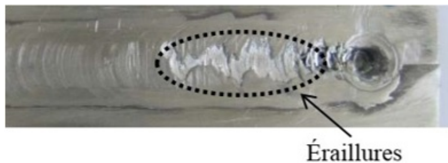
FIGURE 3.5: Le défaut de type écailles de surface.
