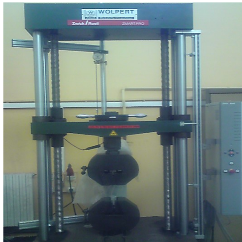
FIGURE 2.16: La machine WOLPERT-AMSLER ZZ220 utilisée pour les essais de traction.
