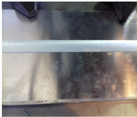
FIGURE 2.8: Joint soudé par FSW.
