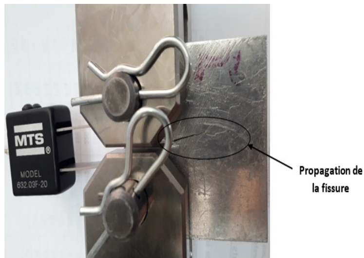
FIGURE 3.20: La propagation de la fissure dans l'éprouvette CT-50.
