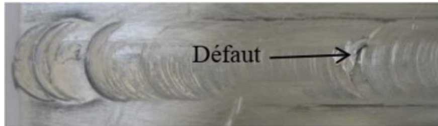
FIGURE 3.4: Le défaut de manque de marquage.
