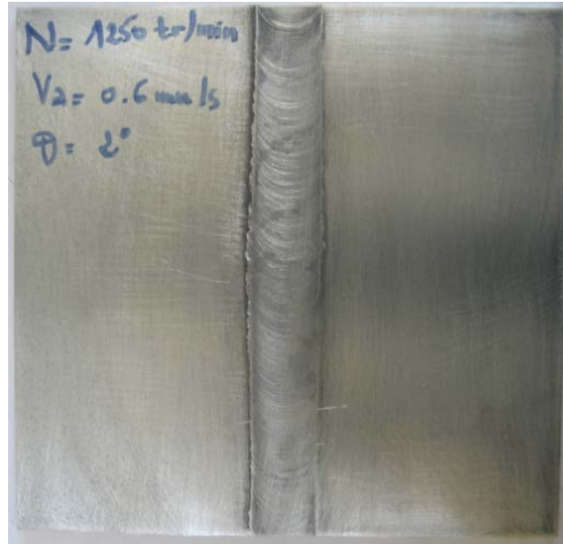
FIGURE 3.1: Plaques d'aluminium 2017A-T451 de 6mm d'épaisseur soudées par FSW.
