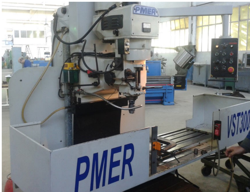
FIGURE 2.3: La fraiseuse utilisée pour le soudage.
