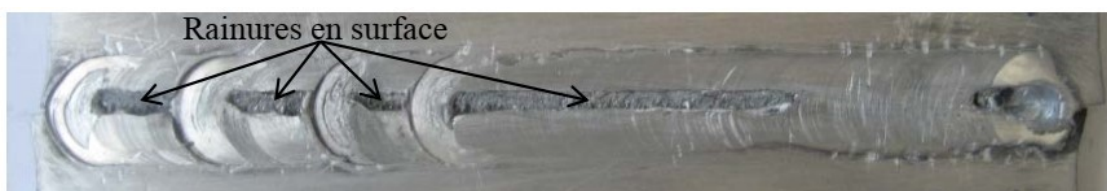
FIGURE 3.6: Le défaut des rainures de surface.
