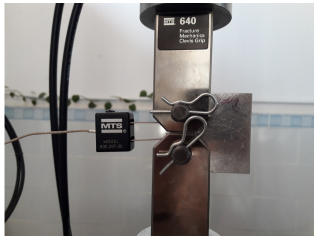
FIGURE 2.22: L'emplacement de l'extensomètre sur l'éprouvette.
