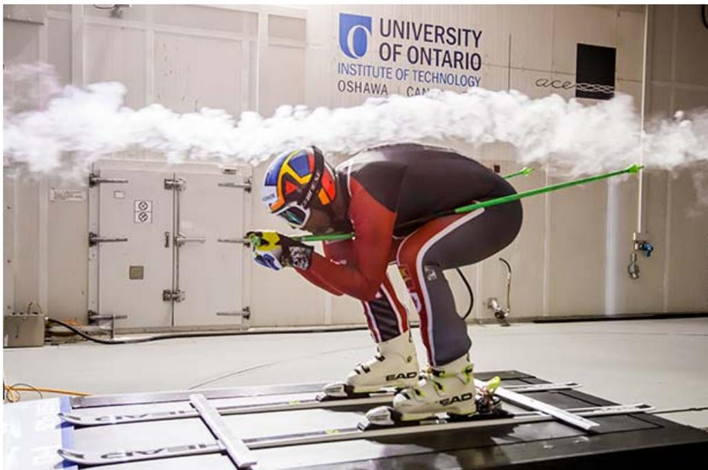
Figure 1-11 Étude de l'écoulement de l'air autour du corps d'un skieur.
