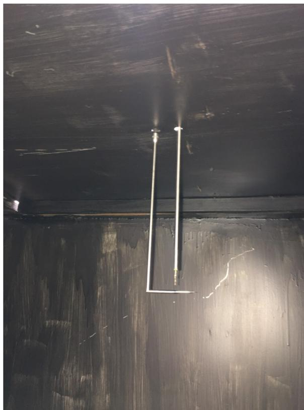
**Figure 2-15** Sonde du fil chaud (à gauche) et sonde de calibration (à droite).
