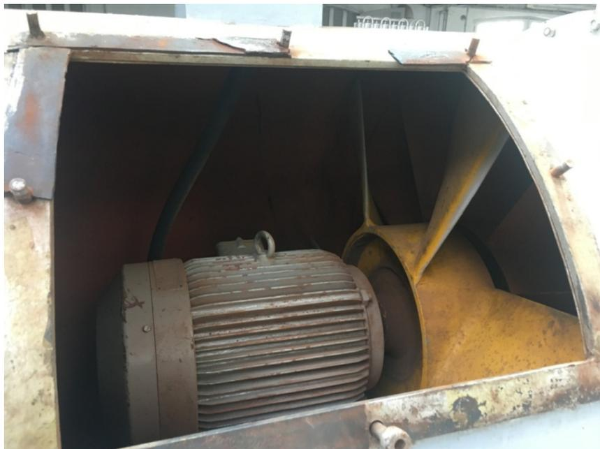
**Figure 2-3 Moteur électrique et ventilateur de la soufflerie.**
