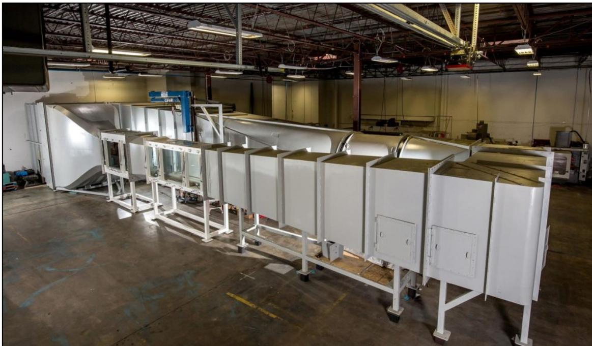
Figure 1-3 Modèle de soufflerie à circuit fermé.
