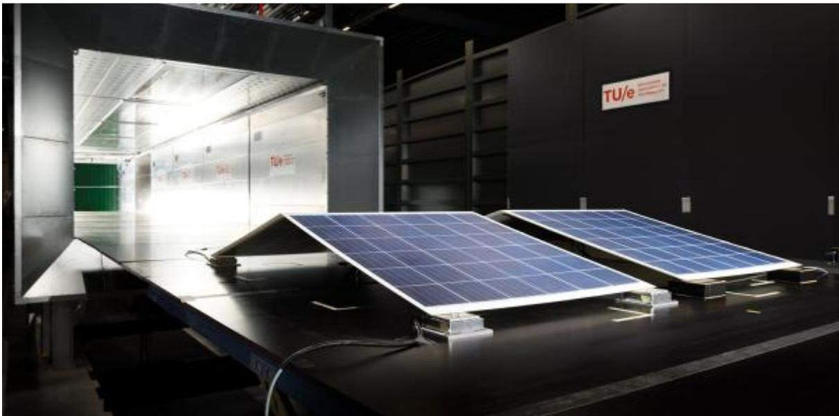
Figure 1-10 Étude de l'effet du vent sur des panneaux solaires.
