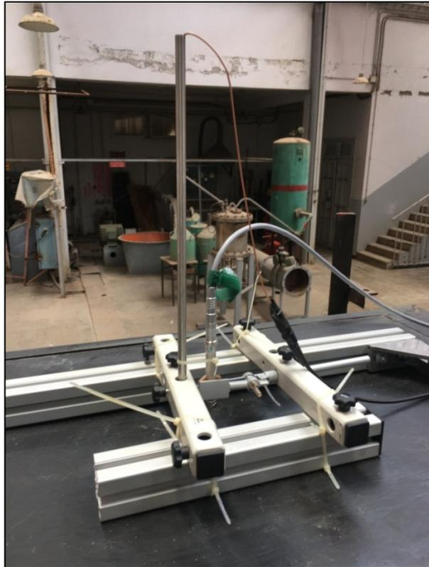
**Figure 2-14** Installation des support du fil chaud.
