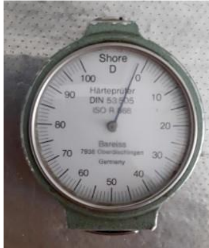
Figure II.8 : Duromètre Shore D.
