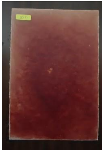
Figure II.5 : Plaque obtenue par compression.
