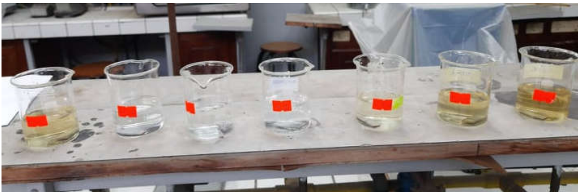
Figure 2.5: Dispositif expérimental de corrosion
