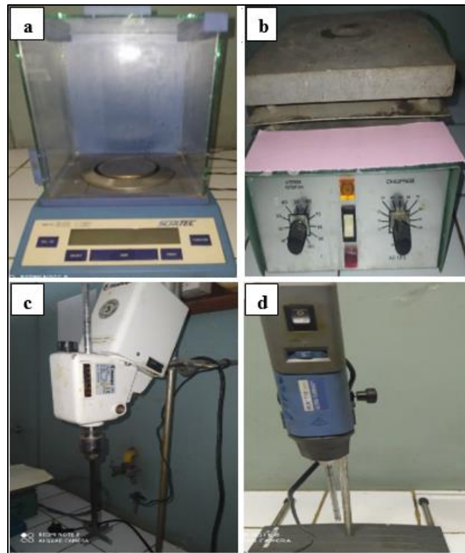
Figure 4.5 Dispositifs utilisés pour la formulation des émulsions (a- Balance SCALTEC SBS 31 ; b- Plaque chauffante ; c - Agitateur Heidolph ; d- Homogénéisateur ULTRA TURAX T10)
