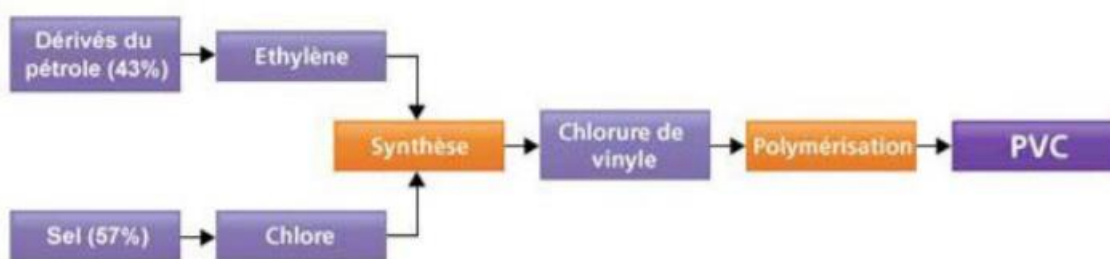
Figure 1.3 : Schéma de fabrication du composant de base : la résine PVC [11].
