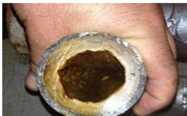
**Figure 2.8** - Corrosion haute température par des sels fondus
