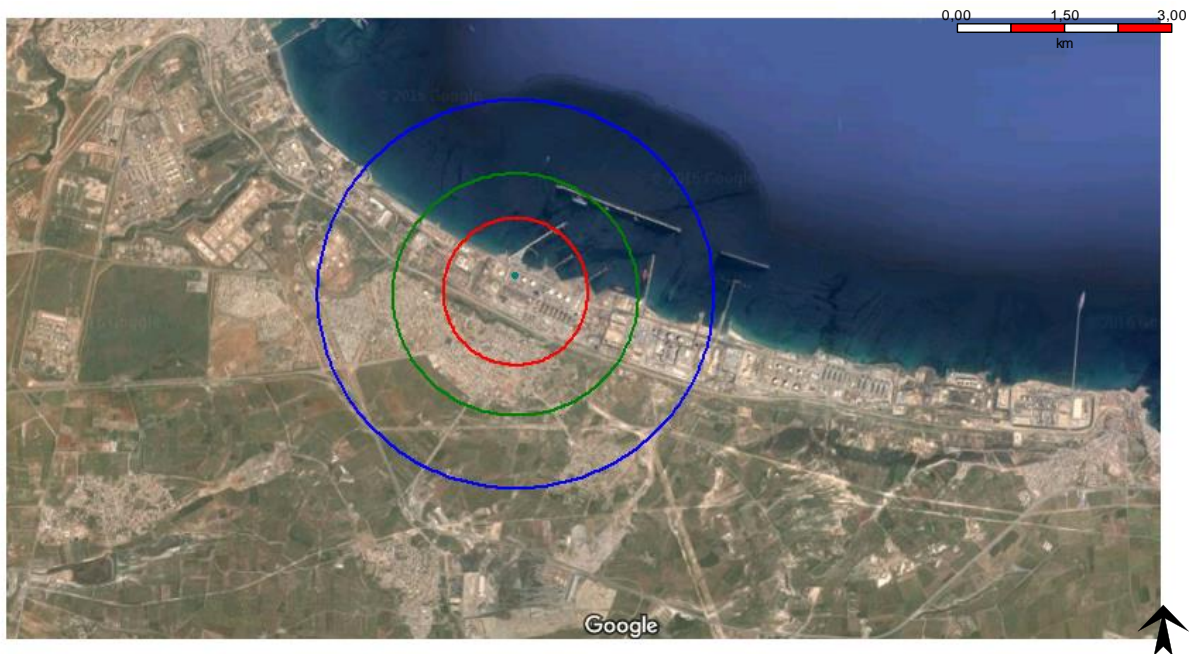
Figure III-6: Distances des effets thermiques du feu de nappe
