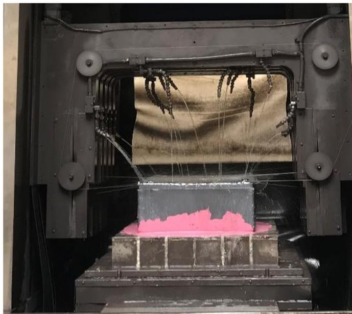
Figure 3.1 : Scie à fil diamanté (CRTSE, 2021)
