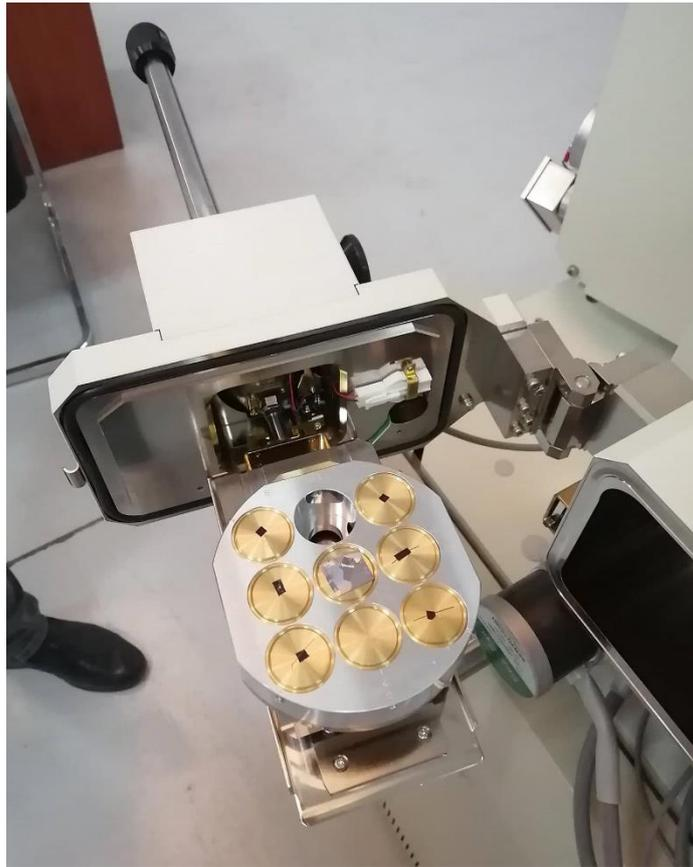
Figure 4.3 : Etape d'introduction de l'échantillon dans l'appareil EPMA
