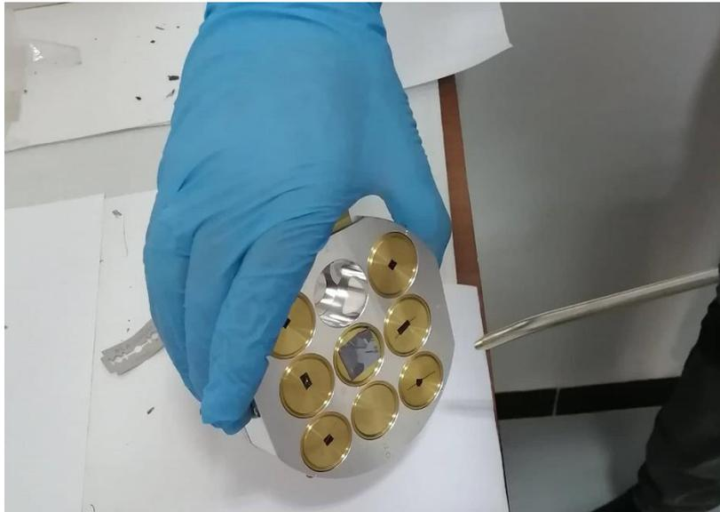
Figure 4.2 : Etape de préparation des échantillons des fils de sciage
