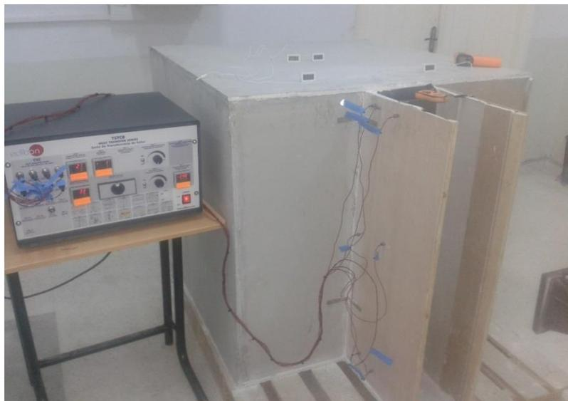
**Figure IV.1 :** Photo montrant la cheminée solaire expérimentale.
