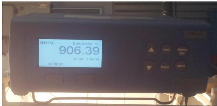
**Figure IV.16 :** Baromètre digital marque DRUCK DPI142.
