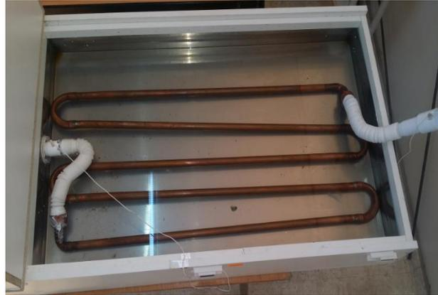
**Figure IV.7** : Photo de l'échangeur de chaleur air-sol.
