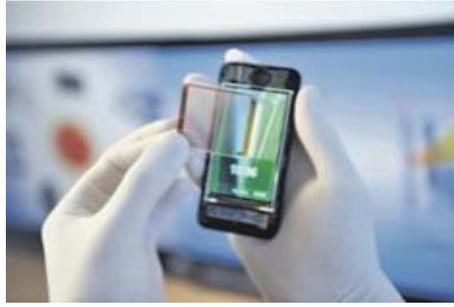
FIGURE 1.11 – Cellule solaire à colorant flexible intégrée à l'écran du téléphone [42].
