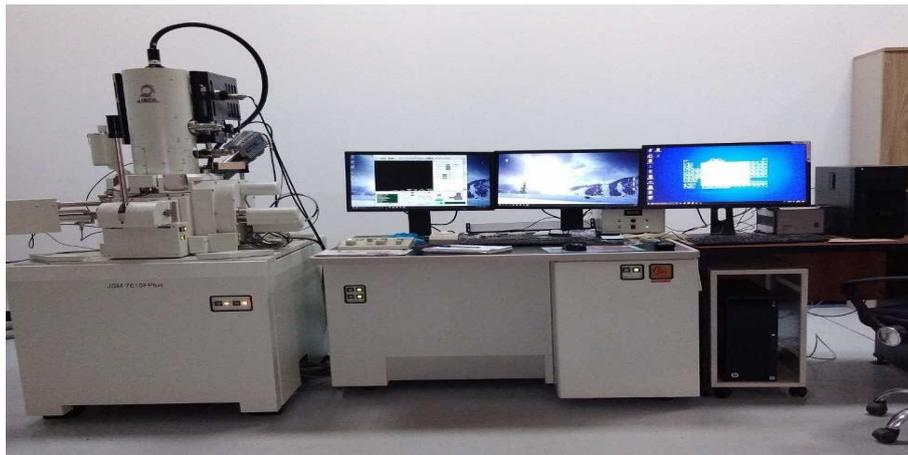
FIGURE 2.15 – Microscope électronique à balayage.
