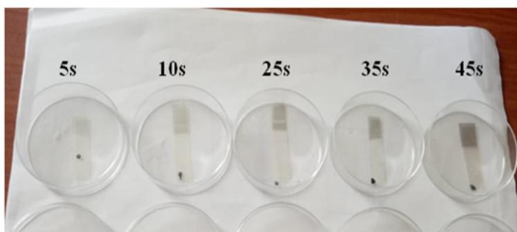
FIGURE 3.2 – Contre-électrodes réalisées avec différents temps de dépôt.
