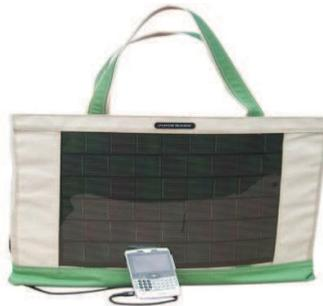
FIGURE 1.10 – Sac équipé de cellules solaires flexibles à colorant [48].
