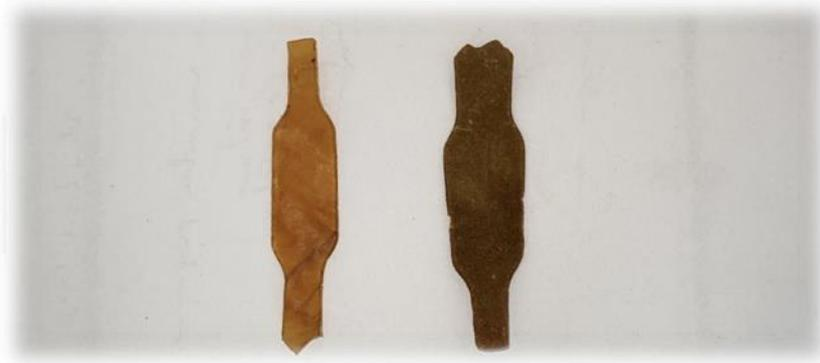
**Figure II.3 :** Echantillons du polypropylène fragilisé par le stéarate de fer non vieilli F2(T) (à gauche) et vieilli F2 (à droite) avant le test d'enfouissement.
