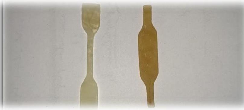
**Figure II.4 :** Echantillons du polypropylène fragilisé par la benzoïne non vieilli F3(T) (à gauche) et vieilli F3 (à droite) avant le test d'enfouissement.
