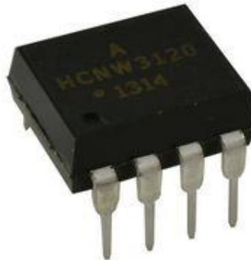
**Figure 3-10** : Circuit intégré Optocoupleur-driver HCNW-3120.
