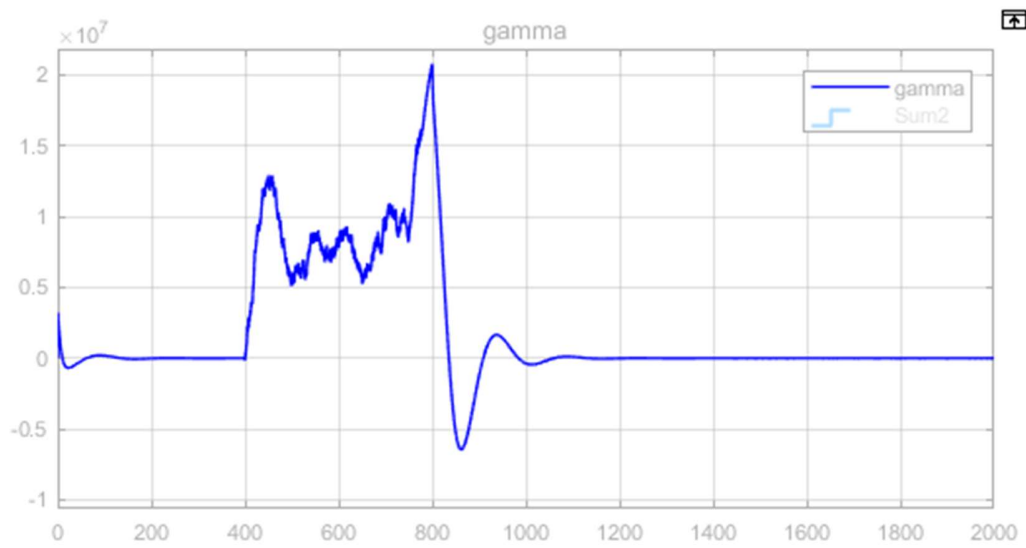
Figure 4.16 Défaut artificiel de la tension (type1)
