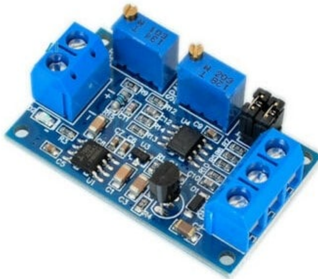
FIGURE 2.21 – Module convertisseur de courant – tension [15]
