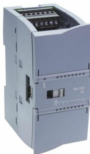
FIGURE 2.7 – Module de sorties analogiques SM 1232 (Réf : 6ES7232-4HD32-0XB0) [1]
