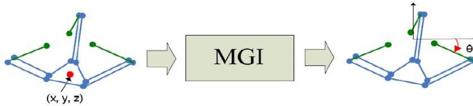
FIGURE 2.4: Modèle géométrique inverse de Delta
