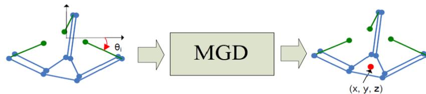
FIGURE 2.1: Modèle géométrique direct de Delta
