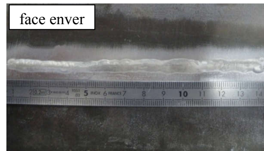
Figure IV -21.Aspect du cordon de soudage TIG alternatif de l'alliage AZ 31.
