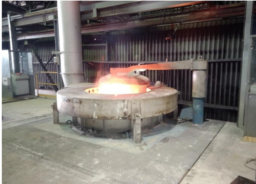
Figure IV.5 : fours de fusion et maintien à moyennes fréquences
