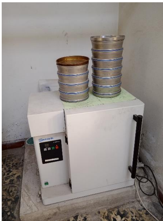
Figure V.4 : dispositif de tamisage avec des tamis de différente taille
