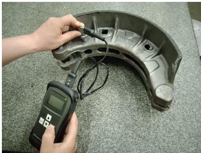
Figure V.19 Contrôle de structure de la pièce par ultrasons
