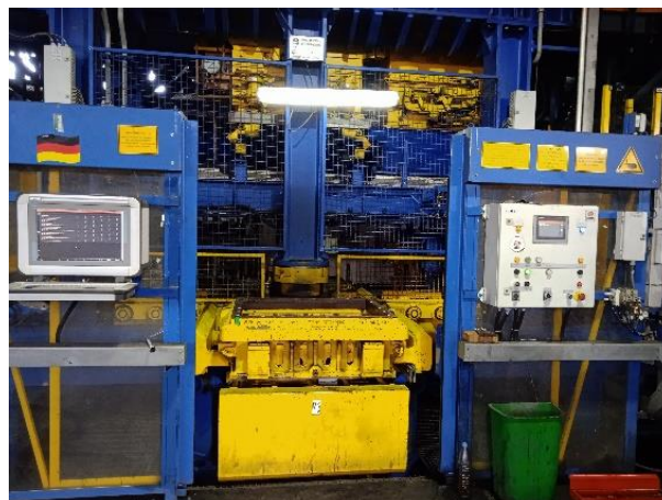
Figure IV.4 : machine de moulage
