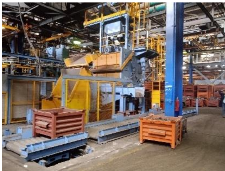
Figure IV.7 : grenailleuse a tapis métallique
