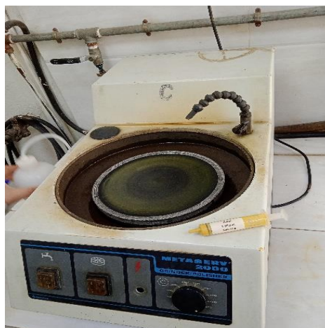
Figure V.12 : Machine de polissage des échantillons pour examens métallographiques.
