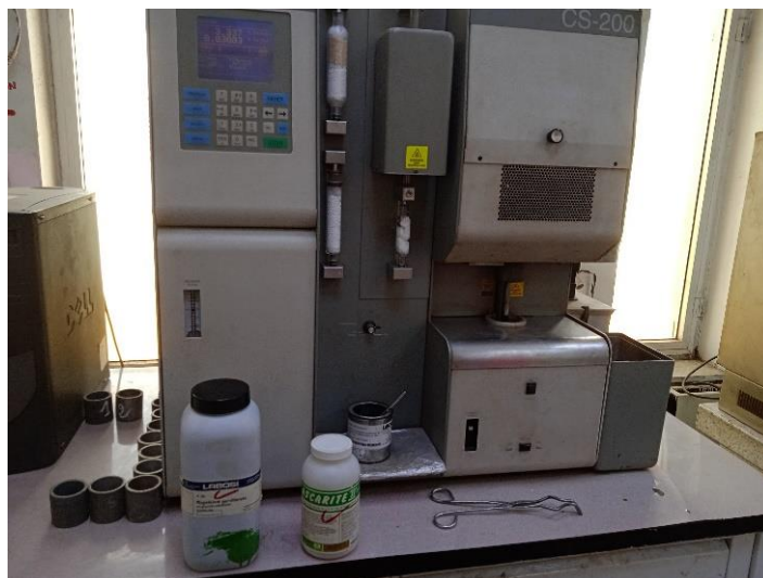
Figure V.17 : Leco CS 200 « carbon suflur determinator »
