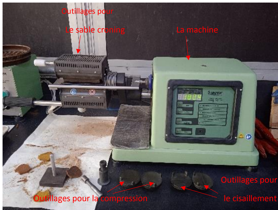
Figure V.2 : dispositif polyvalent pour les essais de cisaillement et compression du sable
