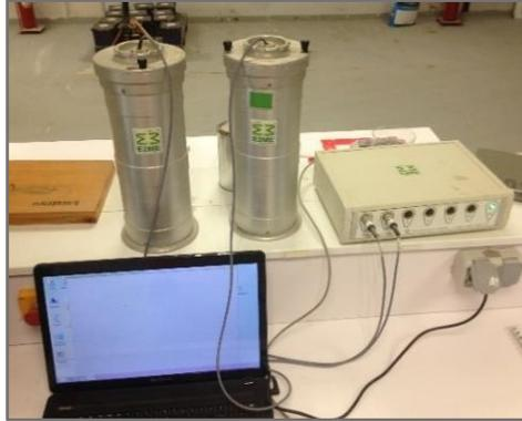
**Fig. 4.15.** Dispositif E2ME pour la calorimétrie semi-adiabatique
