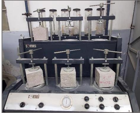
Fig. 4.22. Dispositif de pénétrabilité à l'eau
