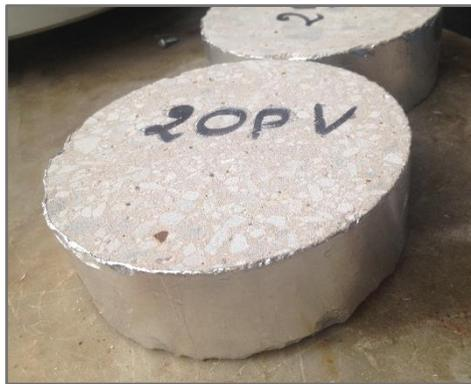
Fig. 4.24. Epreuve cylindrique  $150 \times 50 \text{ mm}^2$
