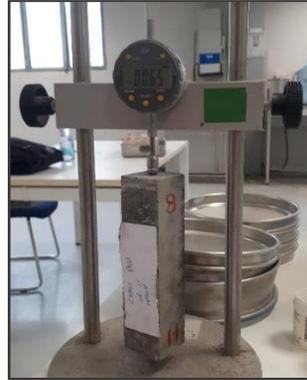
Fig. 4.18. Comparateur pour l'essai de retrait
