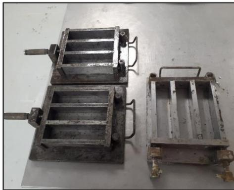
**Fig. 4.17.** Moules de mortiers pour le retrait
