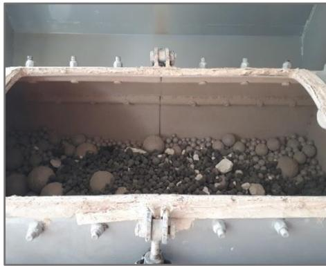
**Fig. 4.1.** Broyeur à boulets
