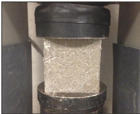
Fig. 4.21 Essai de compression sur éprouvettes de béton cubiques
