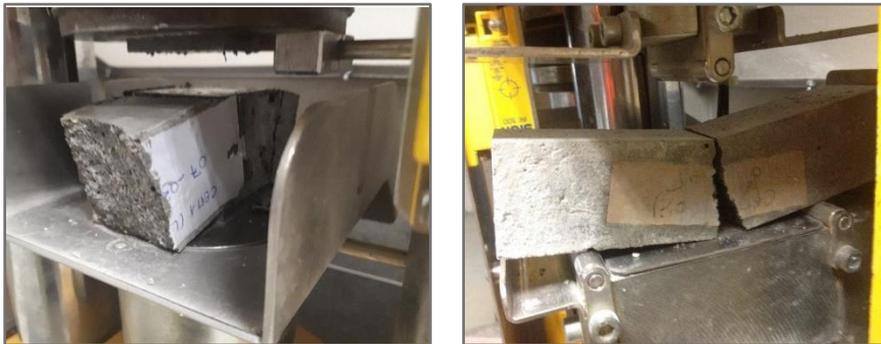
**Fig. 4.16.** Essai de compression et de flexion sur mortier
