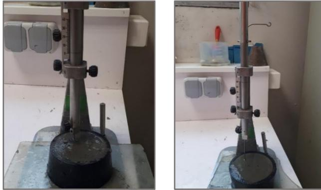
Fig. 4.12. Appareil de Vicat - Début et fin de prise
