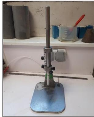
**Fig. 4.11.** Appareil de Vicat - Consistance
