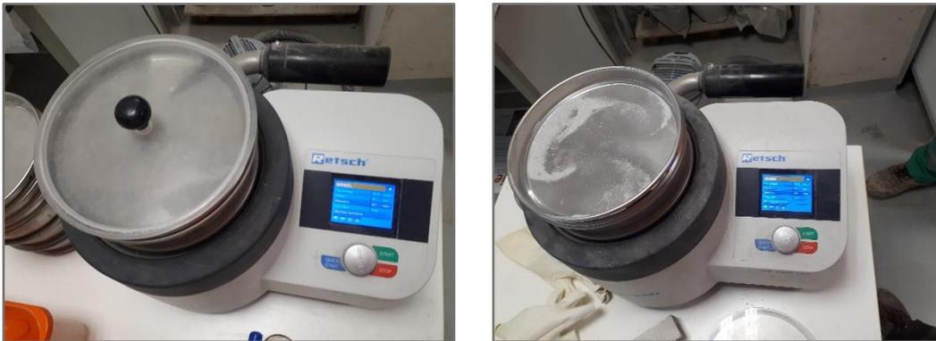
Fig. 4.10. Appareillage pour reufs à 45 $\mu$ m
