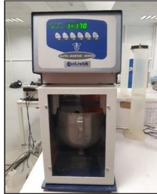
Fig. 4.14. Malaxeur de mortiers et pâtes de ciment
