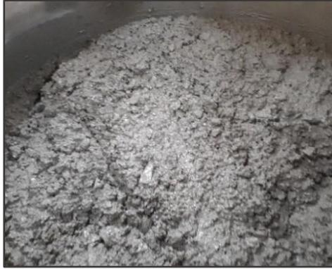
**Fig. 4.19.** Béton frais à base de ciment contenant de la poudre de verre finement broyée
