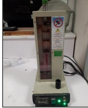
Fig. 4.9. Perméabilimètre Blaine
