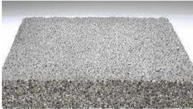
Figure I.5 : Bloc en béton caverneux
