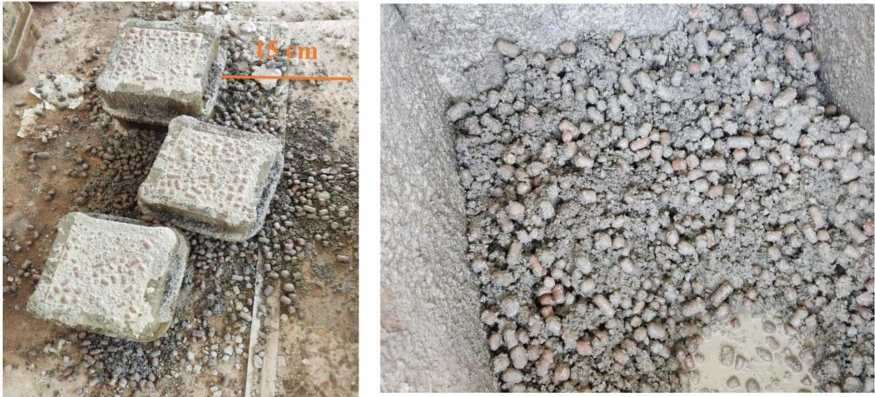
Figure III.2 : Confection des éprouvettes de béton léger
