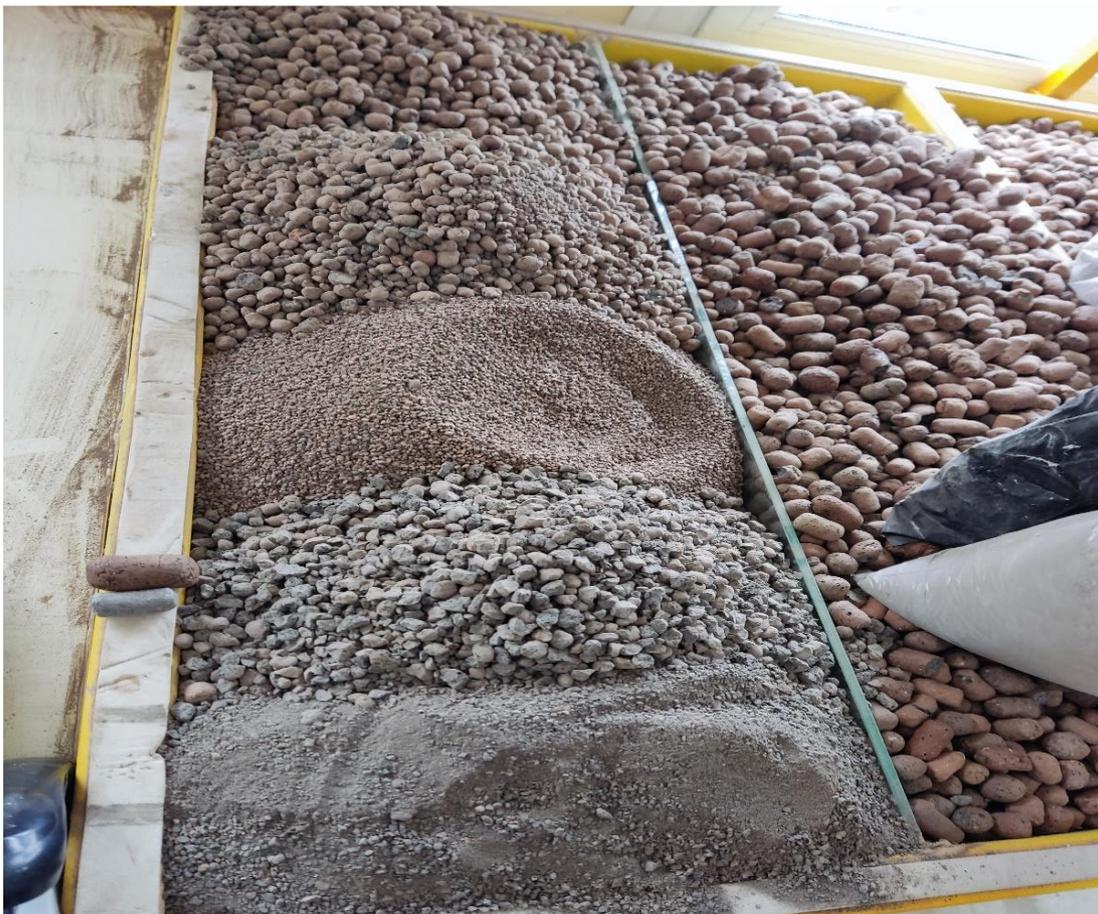
Figure II.1 : Différentes fractions d'argiles expansées
