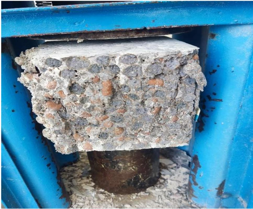
Figure III.6 : Ecrasement par compression du béton léger
