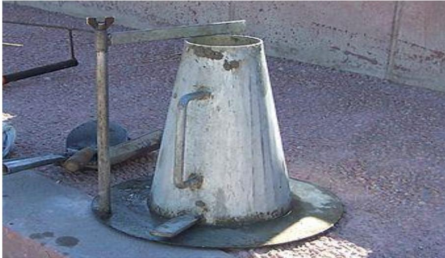
Figure III.3 : essai au cône d'Abrams
