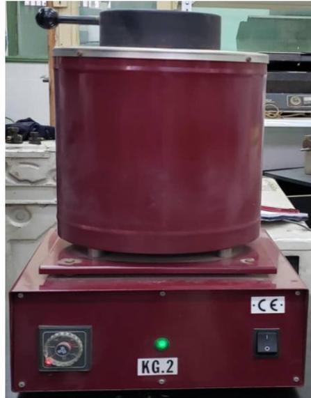
Figure 3-5 : Four électrique.
