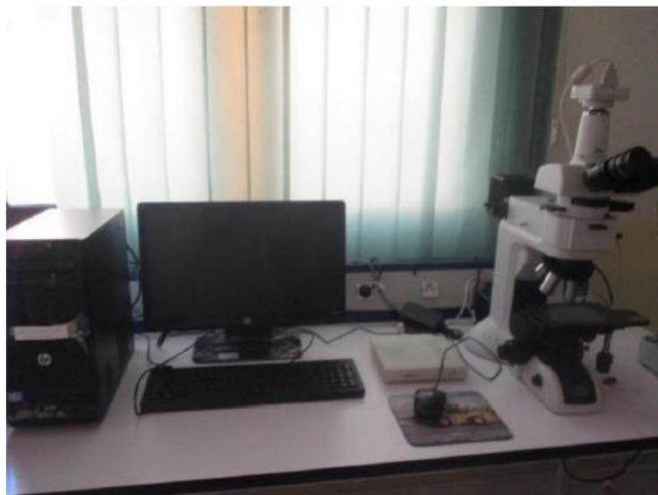
Figure 3-9 : Microscope optique de type « Nikon® Eclipse LV100ND » équipé d'une caméra de type « Nikon® DS-Fi2 ».
