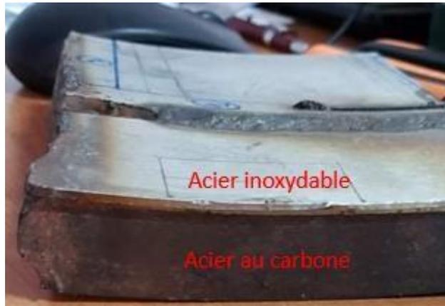
Figure 3-2 : Tôle Cladding Acier X 60/316L.
