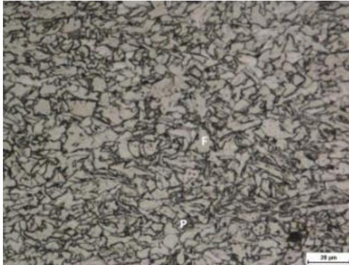
Figure 1-1 : Microstructure d'un acier X60 [4].
