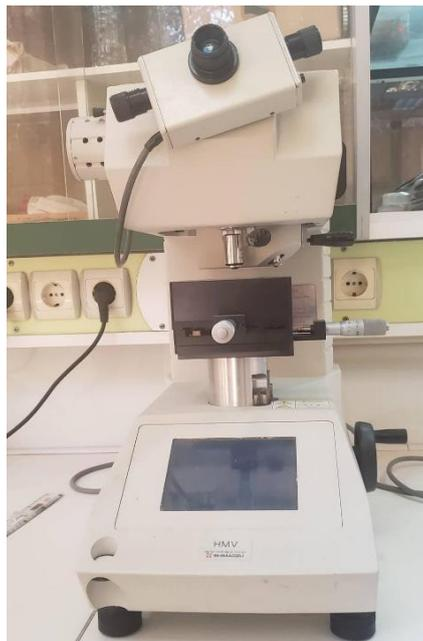
Figure 3-14 : Microduromètre de la marque « BHIMADZU ».
