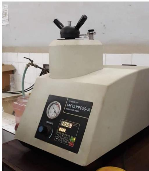
*Figure 3-6 : Enrobeuse de modèle « METAPRESS-A ».*
