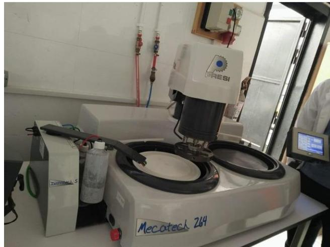
Figure 3-7 : Polisseuse de type « MECOTECH ».
