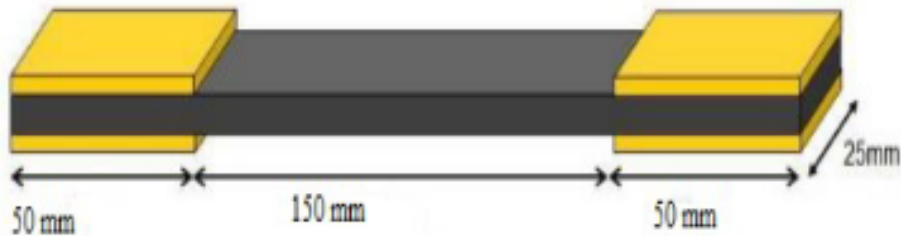
Figure II.12 : La géométrie d'éprouvette d'essai de traction
