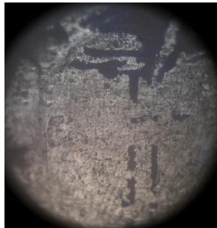
Figure 4-22:Micrographie de l'échantillon E1 après polarisation dans la solution d'acide H2SO4 pH 1.
