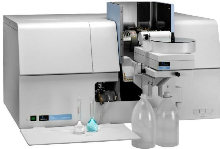
FIGURE 4.6 – Un spectromètre d'absorption atomique
