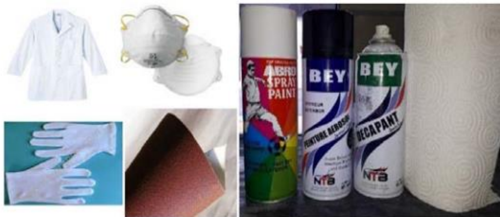
Figure III.16. Les outils utilisés pour l'obtention de mouchetis
