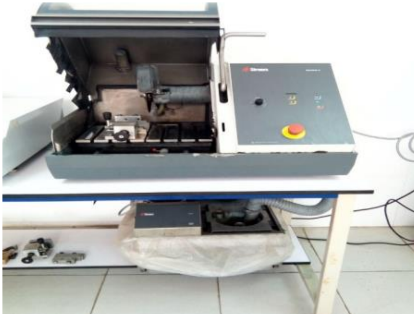
Figure III.10. Tronçonneuse utilisée pour découpage
