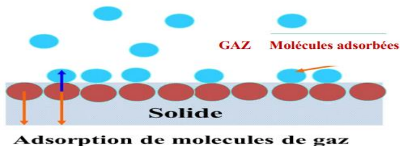
Figure 1.10. Principe du phénomène d'adsorption.
