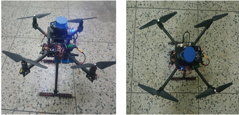
FIG. 1.1 : Plateforme du quadri-rotor équipée par un PIXHAWK4, une carte NVIDIA, un capteur sonore et un lidar 2D
