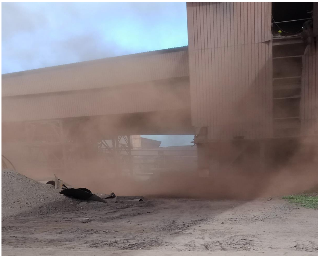
Figure 22 : poussière générée par la comminution
