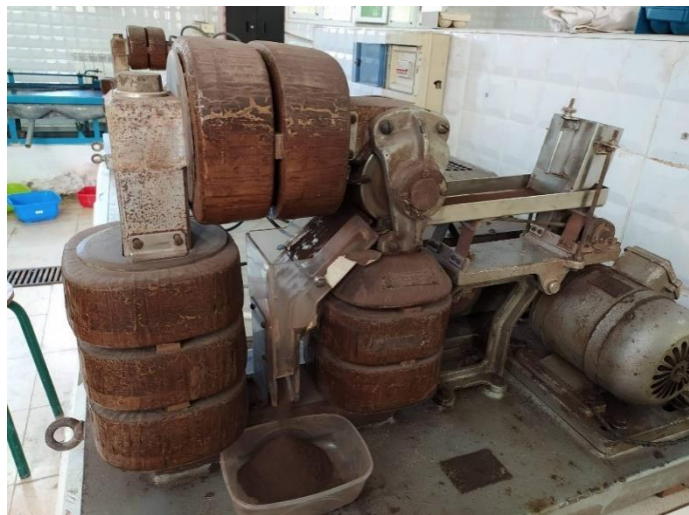
Figure 38 : Séparateur magnétique utilisé au laboratoire de Génie Minier
