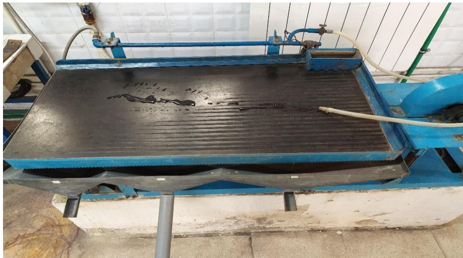
Figure 40 : Table a secousse utilisée au laboratoire de Génie Minier
