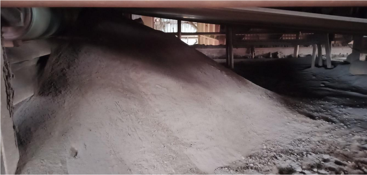
Figure 27 : Effet de la poussière sur la bande transporteuse
