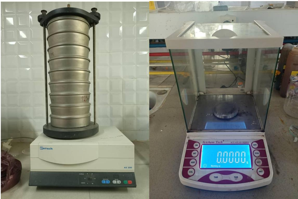
Figure 3. 11: Tamiseuse de type RETSCH AS 200 et balance à précision SCT-ATLAS.
