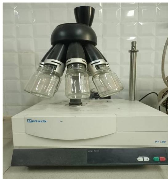
Figure 3. 9: Diviseur d'échantillons à cônes rotatifs RETSCH.
