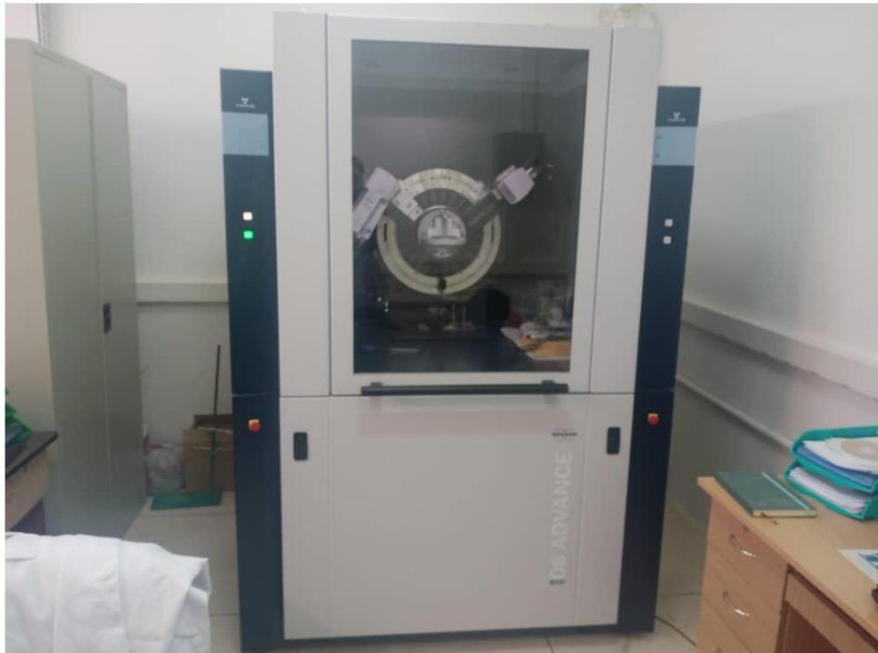
Figure 3. 15: Appareil de Diffraction des Rayons X.
