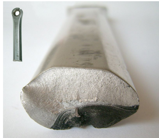
Figure 1.5 : Faciès de rupture de fatigue.[7]
