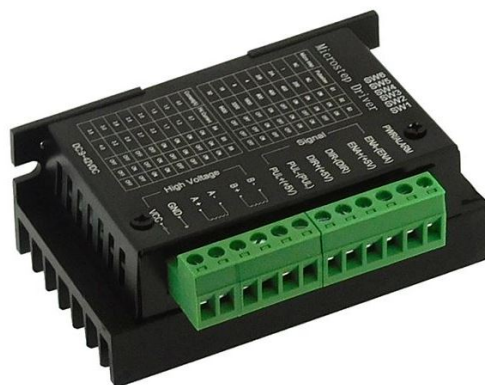
Figure 5.4 : Driver du moteur pas à pas.
