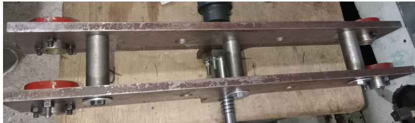
Figure 2.3 : Système de guidage après la première rectification.
