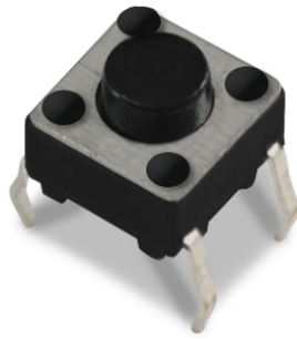
Figure 5.10 : Bouton poussoir pour l'Arduino.
