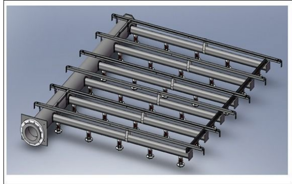
Figure 1-21 : Système de distribution d'eau
