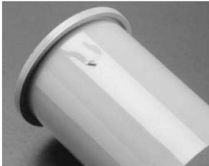
Figure I.14. Pièce représentant une inclusion d'air.
